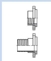
**Losflansch passend für Gegenflansche nach DIN 2632/2633, Lochbild DIN-EN 1092-1 (PN10, bis 16 bar – ab ø450 bis 10 bar)**
